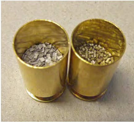
In der Schüttdichte ist das RS 20 bei gleichem Gewicht (hier 7,4 Grains) mit dem Vihtavuori N340 vergleichbar.
