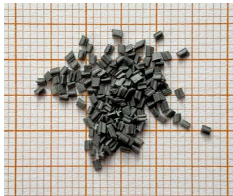
Das RS 14 ist ein poröses, extrudiertes, einbasiges Treibladungsmittel mit einer geringen Schüttdichte von etwa 320 Gramm/Liter. Es ist in seiner Leistung begrenzt und eignet sich daher für stark reduzierte Laborierungen, wie sie etwa im Cowboy-Action-Sport vorkommen.
