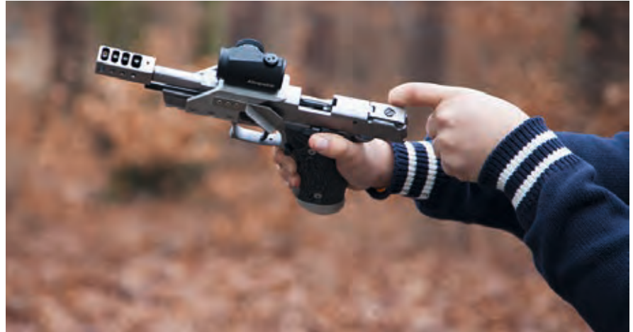
Bei dieser Bettermann-Waffe garantiert die seitlich weit vorn angebrachte Montage-schiene, dass das Aimpoint Micro den Hülsenauswurf nicht blockieren kann.
