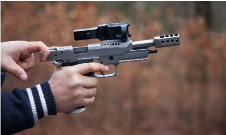
Die seitliche Montage des um 90° gedrehten C-More-Visiers lässt reichlich Platz zum Auswerfen der Hülsen und gewährleistet eine extrem niedrige Visierlinie.
