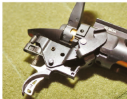
Das Abzugsgewicht des AccuTrigger lässt sich zwischen rund 700 und 1800 Gramm einstellen.
