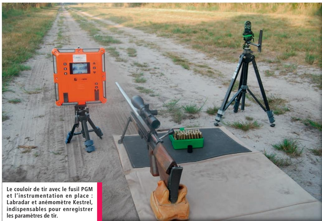
Le couloir de tir avec le fusil PGM et l'instrumentation en place : Labrador et anémomètre Kestrel, indispensables pour enregistrer les paramètres de tir.
