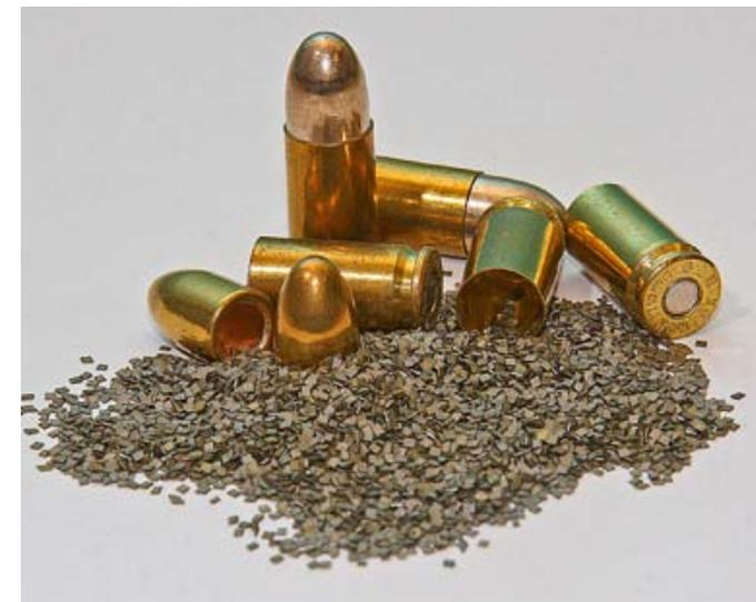
Für das Blättchenpulver der RS20 gibt der Hersteller von Los zu Los maximale Abweichungen von ±12 m/s bei der Mündungsgeschwindigkeit und ±250 bar beim maximalen Gasdruck an.
