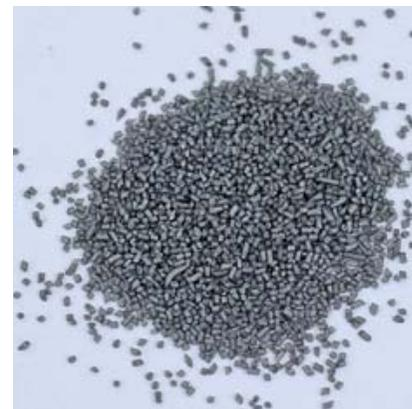
Das RS24 ist ein extrudiertes 1-Loch-Pulver auf Basis Nitrocellulose und mit Nitroglycerin imprägniert, ausgelegt auf hohe Leistung.
