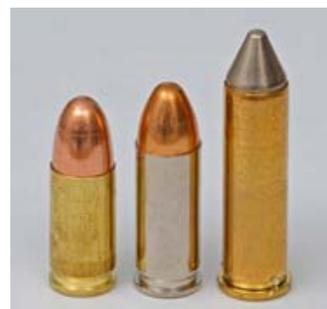
Links die 9 mm Luger, in der Mitte eine .38 Super Auto, rechts .357 Magnum. Während das RS24 in den längeren Patronen keine übermässigen Drücke liefert, ist man mit der 9 mm Luger am Limit. Für normale Laborierungen genügt hier das RS20 vollauf.
