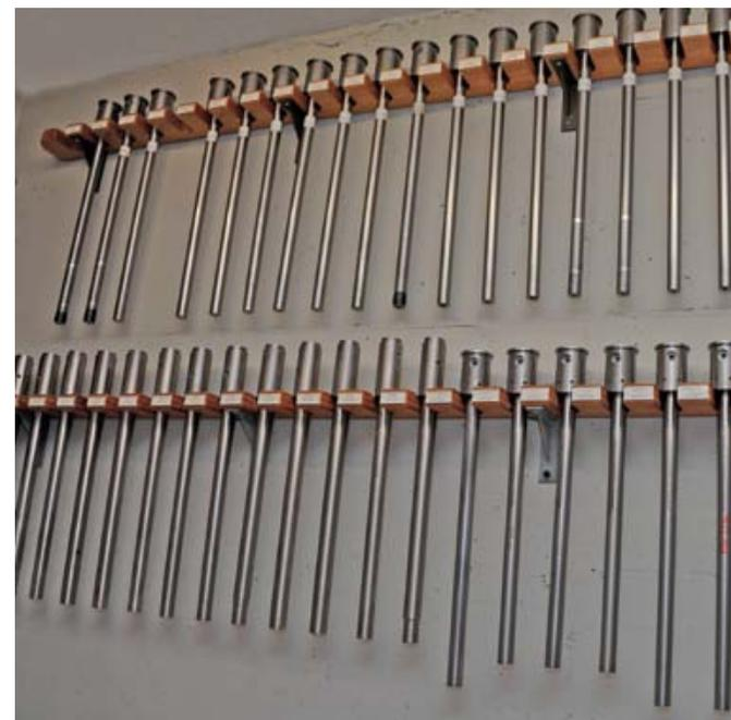
Für das Messlabor stehen zahlreiche Messläufe in den entsprechenden Kalibern zur Verfügung, alle sind hinten angebohrt.
